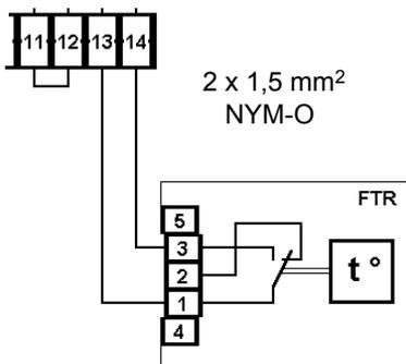
Oberhalb  $-5^{\circ}\text{C}$  erfolgt der Wechsel zwischen Grund- und Bedarfslüftung nach dem vorgegebenen Zeitprogramm. Unterhalb  $-5^{\circ}\text{C}$  wird die Bedarfslüftung reduziert.
