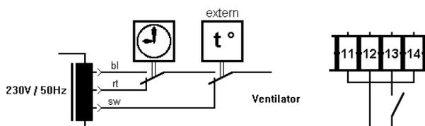
Der externen Schalter ist der Schaltuhr übergeordnet. Der Ventilator wird mit folgenden Spannungsabgriffen verbunden:
