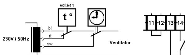
Die Schaltuhr ist dem externen Schalter übergeordnet. Der Ventilator wird mit folgenden Spannungsabgriffen verbunden:
