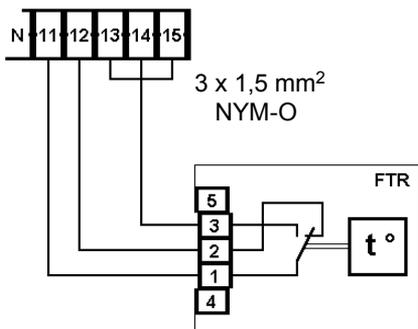
Unterhalb  $30^{\circ}\text{C}$  erfolgt der Wechsel zwischen Grund- und Bedarfslüftung nach dem vorgegebenen Zeitprogramm. Oberhalb  $30^{\circ}\text{C}$  läuft der Ventilator mit voller Leistung.
