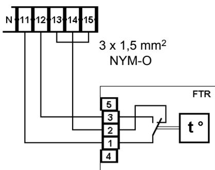
Oberhalb  $0^{\circ}\text{C}$  erfolgt der Wechsel zwischen Grund- und Bedarfslüftung nach dem vorgegebenen Zeitprogramm. Unterhalb  $0^{\circ}\text{C}$  läuft der Ventilator mit einer Minimaldrehzahl.
