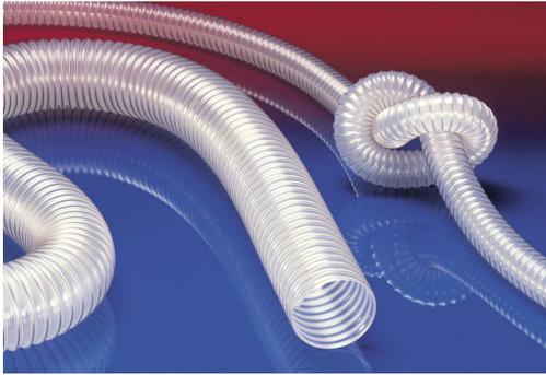
Hochflexible Absaugschläuche für die Lüftungs- und Klimatechnik. Die Federstahlspirale ist in die Wandung eingebettet und dadurch ausgezeichnet gegen Korrosion geschützt. Die Schläuche sind auch bei kleinen Krümmungsradien sehr formstabil und abknicksicher. Alle Typen sind gas- und flüssigkeitsdicht und weisen eine gute chemische Beständigkeit auf. Es ist aber zu beachten, daß auch Kunststoffe von bestimmten Chemikalien angegriffen werden.
