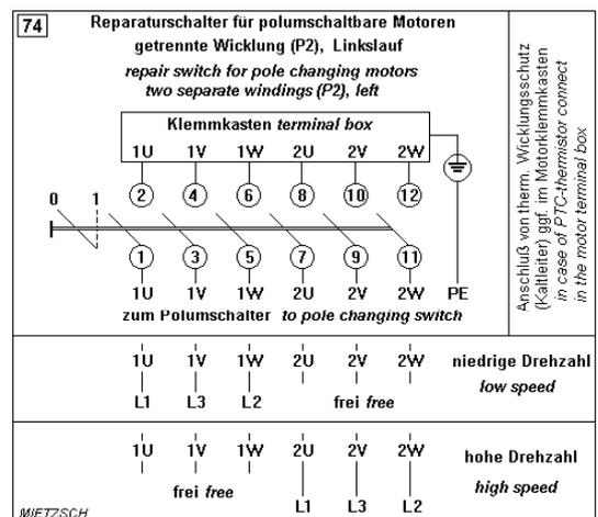
Die dargestellten Schaltbilder gelten für die Drehrichtung links. Zur Änderung der Drehrichtung sind zwei Anschlüsse der Zuleitung zu tauschen (z.B. L2 und L3). Die Dachventilatoren VRR/702 und VRV, die Kanalventilatoren VRK und die Ventilatorbox VRB werden standardmäßig in der Drehrichtung links geliefert.
