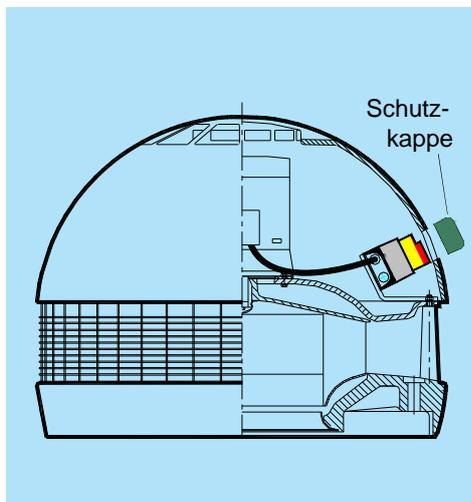
Durch den Schalter RS wird bei Wartungs- und Reparaturarbeiten der Ventilator vollständig vom Netz getrennt. Unfallgefahr durch unkontrolliertes Einschalten wird dadurch ausgeschlossen.
