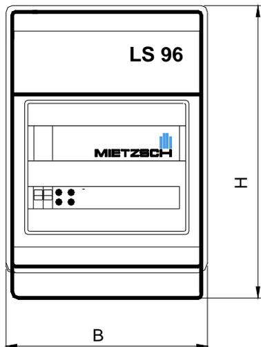
Mit der Lüftersteuerung LS 96 bieten wir eine Kompaktlösung zur Schaltung von Ventilatoren mit Drehstrommotoren. Der Schaltschrank enthält alle Schalt- und Bedienelemente, Betriebsmeldeleuchten sowie ein Motorvollschutzgerät mit Störmeldung. Der Ventilator ist deshalb in der Sonderausführung TS (mit thermischem Wicklungsschutz) zu bestellen.
