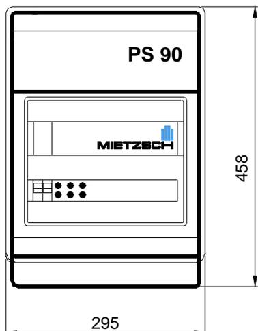
Mit dem Polumschalter PS 90 bieten wir eine Kompaktlösung zur Drehzahlumschaltung von Ventilatoren mit polumschaltbaren Motoren.
