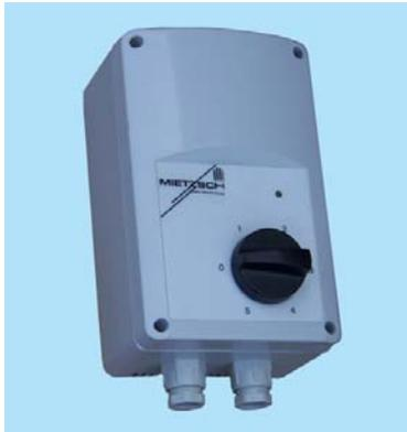
Der transformatorische 5-Stufenschalter RE dient zur Drehzahlstellung von Ventilatoren mit Außenläufermotoren. Die sinusförmige Stellspannung verursacht keine zusätzlichen Motorgeräusche und keinerlei Netzrückwirkungen. Das Gerät enthält eine eingebaute Sicherung als Kurzschlußschutz und eine Betriebsmeldeleuchte.
