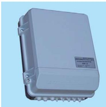
Die Steuerung ZSK dient zur zeitabhängigen Drehzahlstellung von Ventilatoren mit Außenläufermotoren. Die transformatorische Spannungsstellung verursacht keine zusätzlichen Motorgeräusche und keinerlei Netzrückwirkungen. Die Version ZTSK ermöglicht zusätzlich eine temperaturabhängige Stellung. Vorzugsweise wird das Gerät in Zentrallüftungsanlagen zur Realisierung eines gestuften Betriebes eingesetzt.
