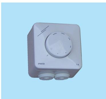
Die Drehzahlsteller ES dienen zur manuellen Stellung und gleichzeitig zum Aus/Einschalten von Ventilatoren mit Außenläufermotoren. Sie arbeiten nach dem Prinzip des Phasenanschnittes.
