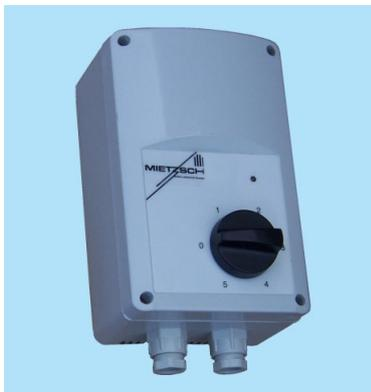
Der transformatorische 5-Stufenschalter RE dient zur Drehzahlstellung von Ventilatoren mit Außenläufermotoren. Die sinusförmige Stellspannung verursacht keine zusätzlichen Motorgeräusche und keinerlei Netzrückwirkungen. Das Gerät enthält eine eingebaute Sicherung als Kurzschlussschutz und eine Betriebsmeldeleuchte.
