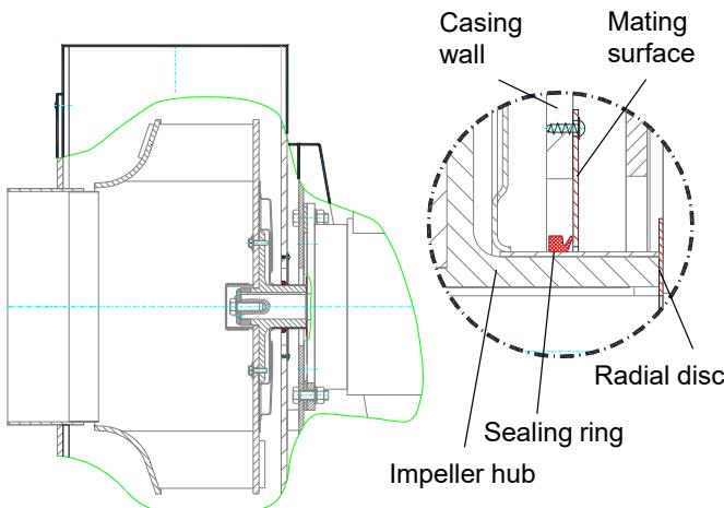
Genügt diese "Aerodynamische Gehäuseabdichtung" nicht, z.B. wenn die Gefahr besteht, dass bei Stillstand aggressives Gas austreten kann, so wird eine Wellendichtung eingesetzt.
