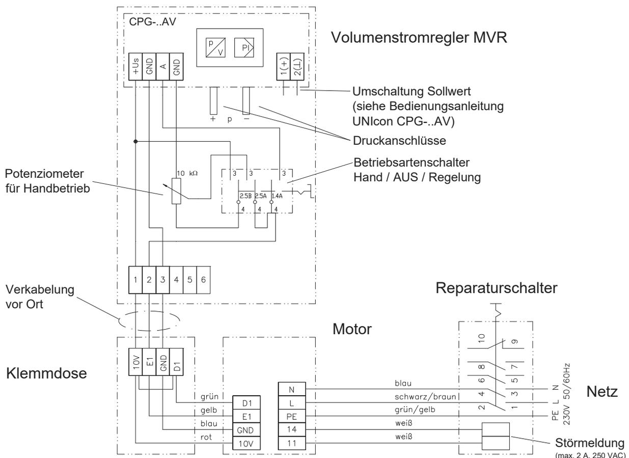
**Netzanschluß** Klemmen L, N und PE am Reparaturschalter
