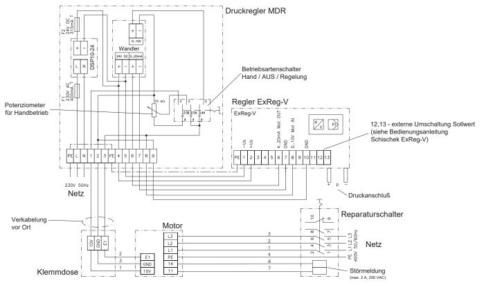
Netzanschluß Klemmen L1, L2, L3 und PE am Reparaturschalter
