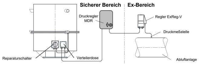
Die Ventilatoren der Baureihe VRV...-EC-MDR wurden auf der Basis der bewährten der Baureihe VRV als Ergänzung zu den bei Kunststoff-Dachventilatoren vorwiegend verwendeten drehzahlregelbaren Antrieben in der Kombination von Asynchronmotor und Frequenzumrichter (Ausführung mit Druckregelung) entwickelt.
