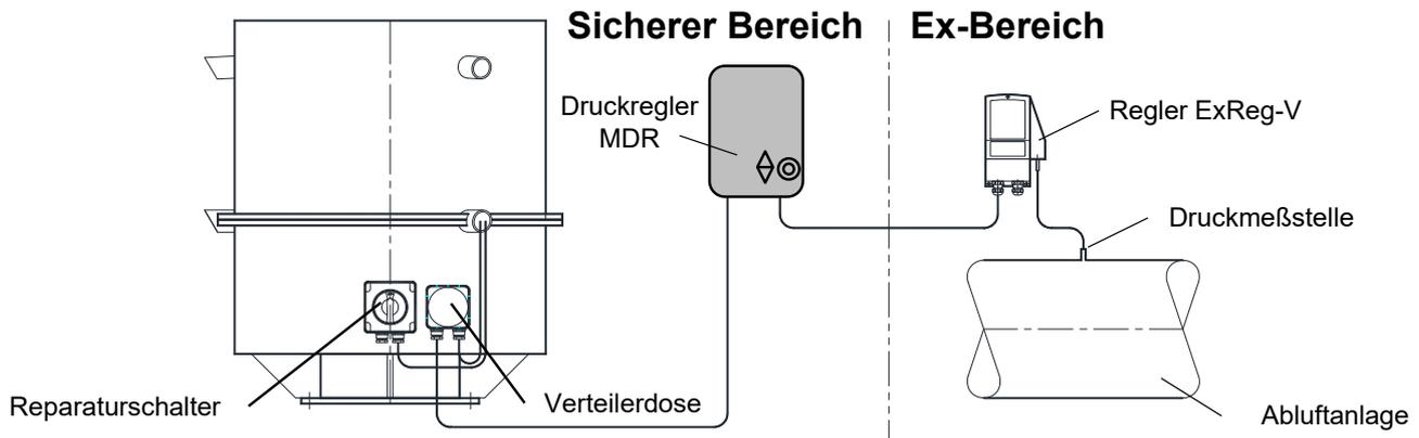
Die Ventilatoren der Baureihe VRV...-EC-MDR wurden auf der Basis der bewährten der Baureihe VRV als Ergänzung zu den bei Kunststoff-Dachventilatoren vorwiegend verwendeten drehzahlregelbaren Antrieben in der Kombination von Asynchronmotor und Frequenzumrichter (Ausführung mit Druckregelung) entwickelt. Für den Einsatz und Betrieb gelten auch alle Festlegungen und Hinweise in der Betriebsanleitung „Dachventilatoren VRV“.
