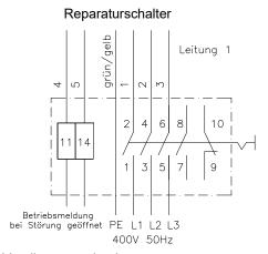
Die Stromversorgung wird im Reparaturschalter angeschlossen, der am Ventilator montiert ist.
