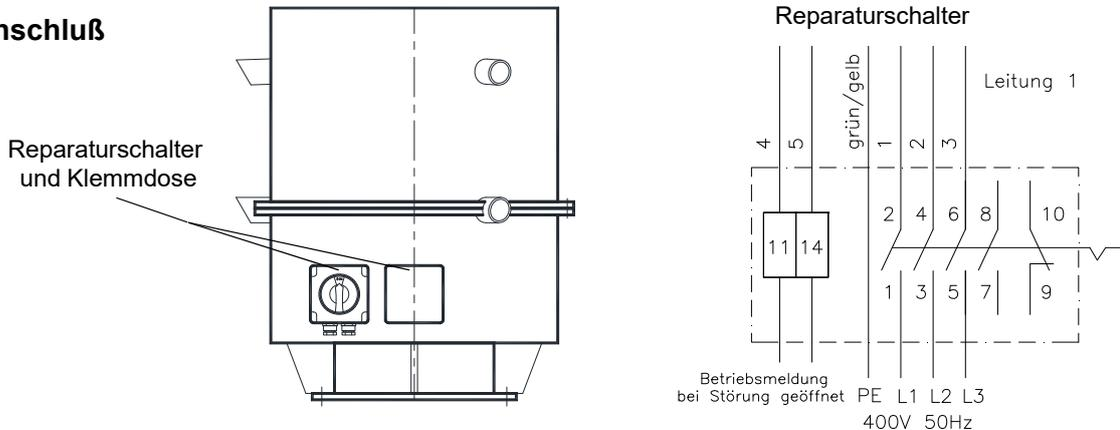
Die Stromversorgung wird im Reparaturschalter angeschlossen, der am Ventilator montiert ist.
