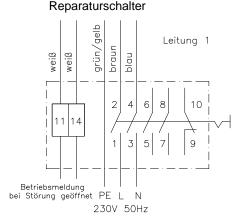
Die Stromversorgung wird im Reparaturschalter angeschlossen, der am Ventilator montiert ist.
