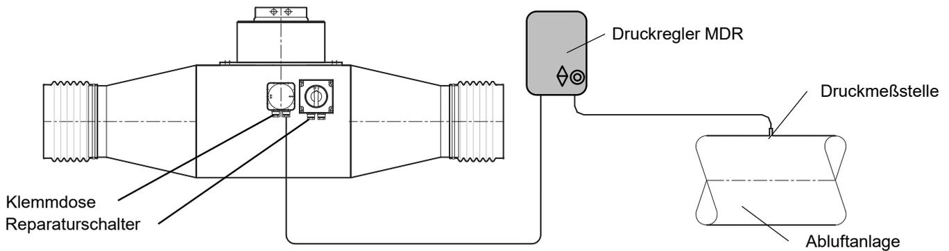
Die Ventilatoren der Baureihe VRK...-EC-MDR wurden auf der Basis der bewährten der Baureihe VRK als Ergänzung zu den bei Kunststoff-Kanalventilatoren vorwiegend verwendeten drehzahlregelbaren Antrieben in der Kombination von Asynchronmotor und Frequenzumrichter (Ausführung mit Druckregelung) entwickelt.
