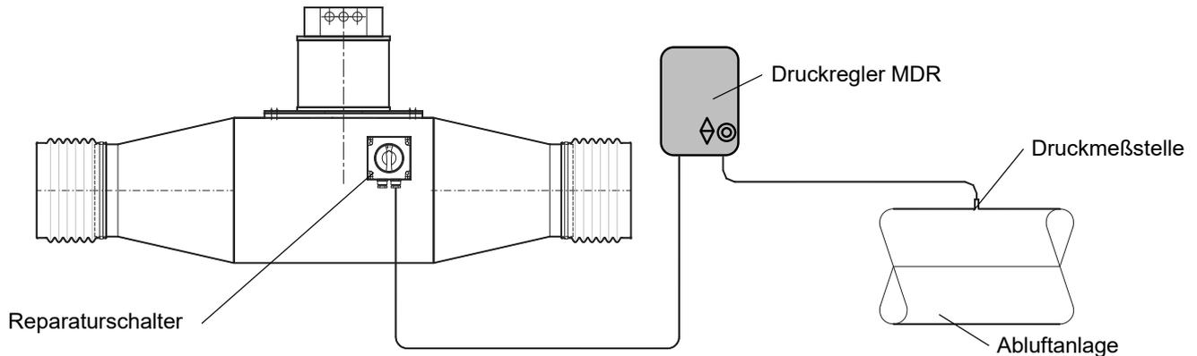
Die Ventilatoren der Baureihe VRK...-EC-MDR wurden auf der Basis der bewährten der Baureihe VRK als Ergänzung zu den bei Kunststoff-Kanalventilatoren vorwiegend verwendeten drehzahlregelbaren Antrieben in der Kombination von Asynchronmotor und Frequenzumrichter (Ausführung mit Druckregelung) entwickelt.
