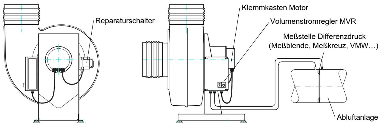
Die Ventilatoren der Baureihe VRE...-EC-VR wurden auf der Basis der bewährten der Baureihe VRE als Ergänzung zu den bei Kunststoff-Radialventilatoren vorwiegend verwendeten drehzahlregelbaren Antrieben in der Kombination von Asynchronmotor und Frequenzumrichter (Ausführung mit Druckregelung) entwickelt.
