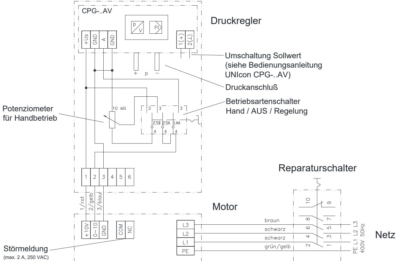
**Netzanschluß** Klemmen L, N und PE am Reparaturschalter
