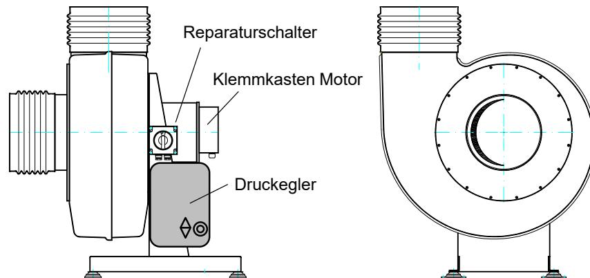
Die Ventilatoren der Baureihe VRE...-EC-DR wurden auf der Basis der bewährten der Baureihe VRE als Ergänzung zu den bei Kunststoff-Radialventilatoren vorwiegend verwendeten drehzahlregelbaren Antrieben in der Kombination von Asynchronmotor und Frequenzumrichter (Ausführung mit Druckregelung) entwickelt.
