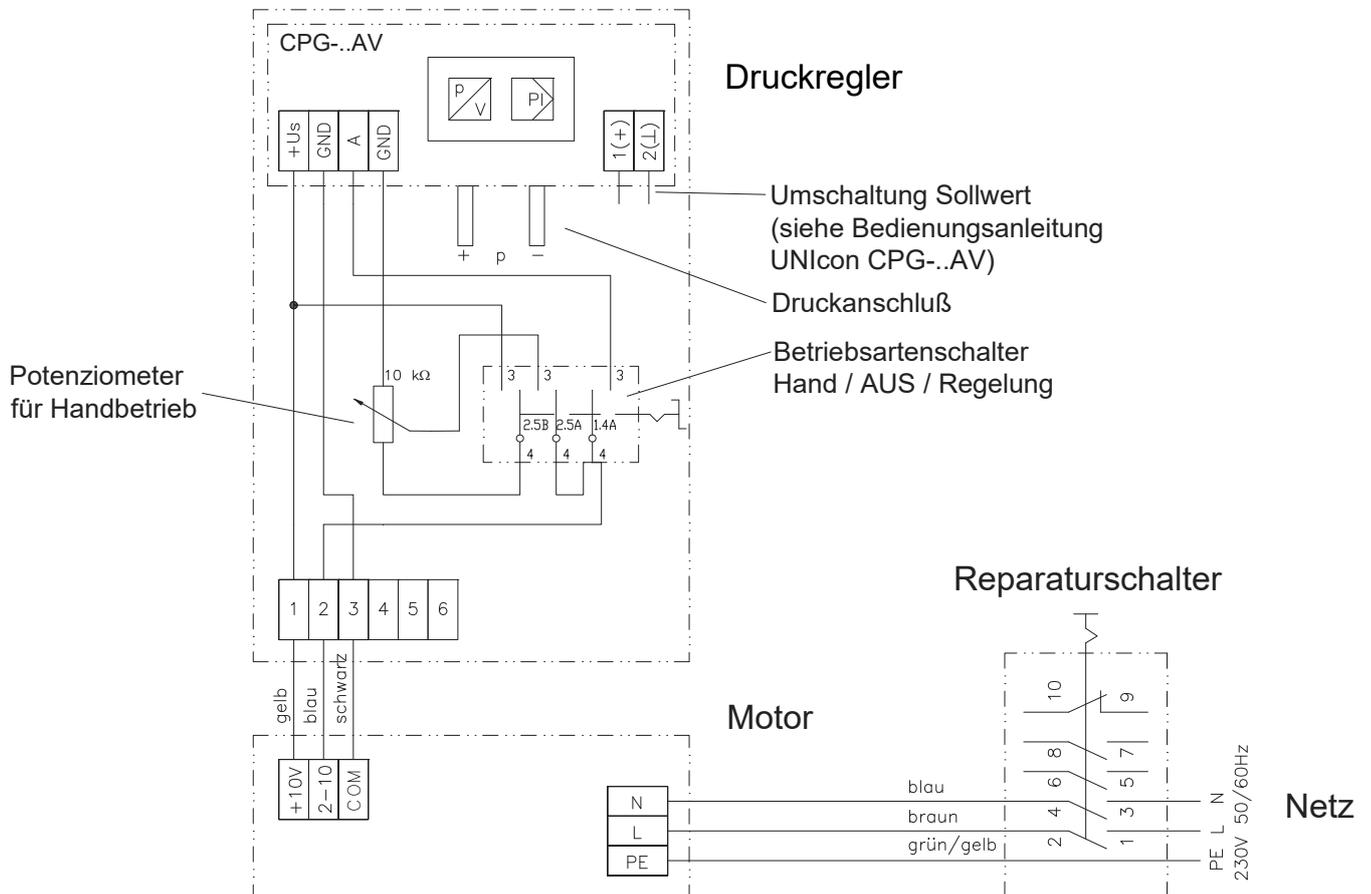
**Netzanschluß** Klemmen L, N und PE am Reparaturschalter
