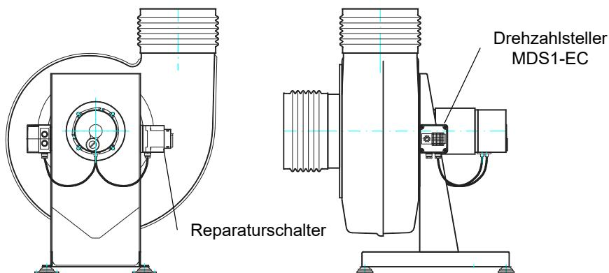
Die Stromversorgung wird im Reparaturschalter angeschlossen, der am Ventilator montiert ist.
