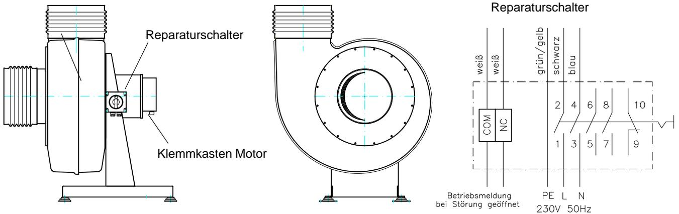
Die Stromversorgung wird im Reparaturschalter angeschlossen, der am Ventilator montiert ist.
