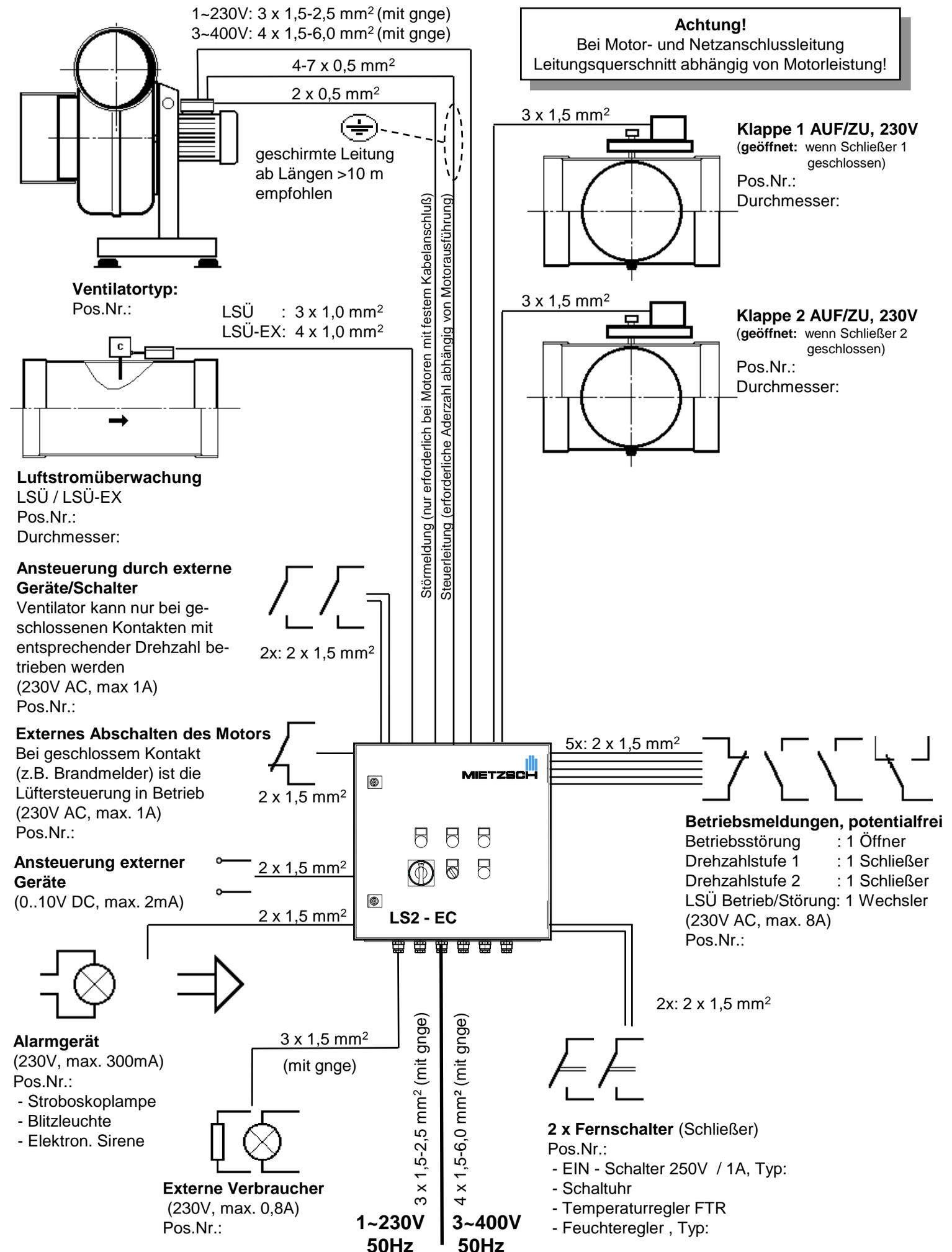
Der jeweilige Kabeltyp ist entsprechend den Einsatzbedingungen und der Verlegeart auszuwählen. Der Geräteanschluß erfolgt nach den jeweiligen Klemmplänen, die den Geräten beiliegen ( insbesondere Bedienungsanleitung).
