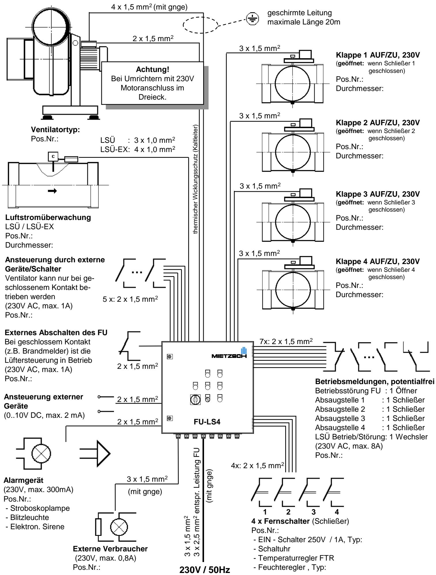
Der jeweilige Kabeltyp ist entsprechend den Einsatzbedingungen und der Verlegeart auszuwählen. Der Geräteanschluß erfolgt nach den jeweiligen Klemmplänen, die den Geräten beiliegen (insbesondere Bedienungsanleitung).
