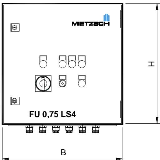
Mit der Lüftersteuerung FU-LS4 bieten wir eine Kompakt-lösung zum drehzahlvariablen Betrieb von Ventilatoren auf der Basis eines Frequenzumrichters an. Die Steuerung wird eingesetzt, wenn über einen Ventilator vier beliebige Leistungsstufen realisiert werden und gleichzeitig Klappen mit AUF/ZU - Stellantrieben angesteuert werden sollen.
