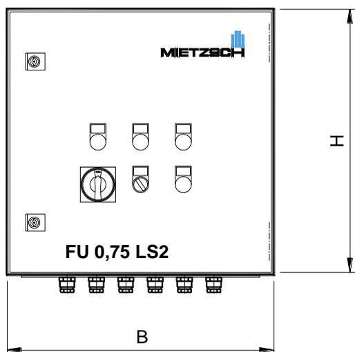
Mit der Lüftersteuerung FU-LS2 bieten wir eine Kompakt-lösung zum drehzahlvariablen Betrieb von Ventilatoren auf der Basis eines Frequenzumrichters an. Die Steuerung wird eingesetzt, wenn über einen Ventilator zwei beliebige Leistungsstufen realisiert werden und gleichzeitig Klappen mit AUF/ZU - Stellantrieben angesteuert werden sollen.
